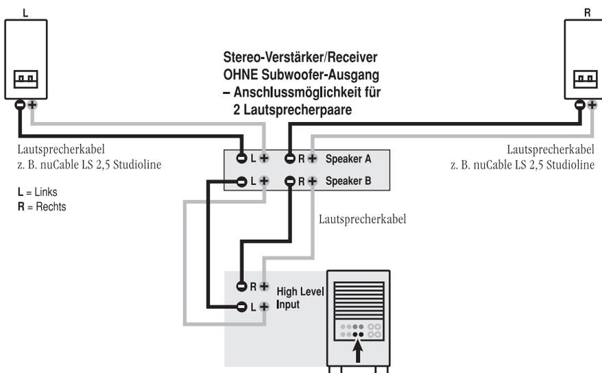
**1 b):** Wenn der Verstärker/Receiver Anschlüsse für *zwei* Lautsprecherpaare (*Speaker A* und *Speaker B*) hat, dann werden die Lautsprecher an den einen und der AW-560 an den anderen Speaker-Anschluss angeschlossen und beide Lautsprecherpaare eingeschaltet.
