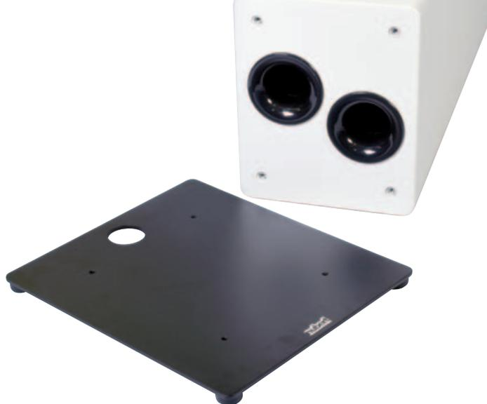
Zwei trompetenförmige Reflexrohre arbeiten auf die Lücke zwischen Boden und Stahlsockel. So ist eine immer gleiche Ankopplung an den Raum gewährleistet, Luftgeräusche dringen nicht zum Hörer.
