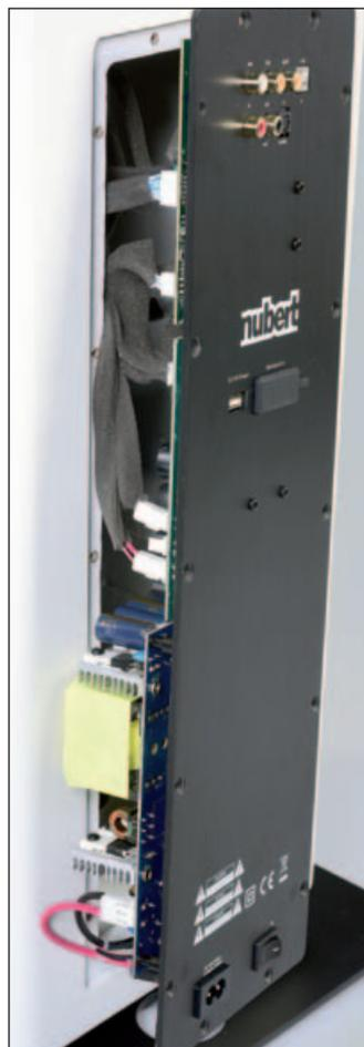
Die Terminalplatte dient als Kühlkörper; neben USB-S/PDIF- und Analog-In gibt es auch Spannung für Bluetooth-Dongles.
