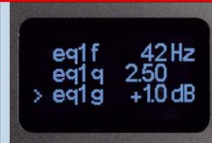
Güte und Gain der ausgewählten Mittenfrequenz können in 0,5er-Schritten geändert werden
