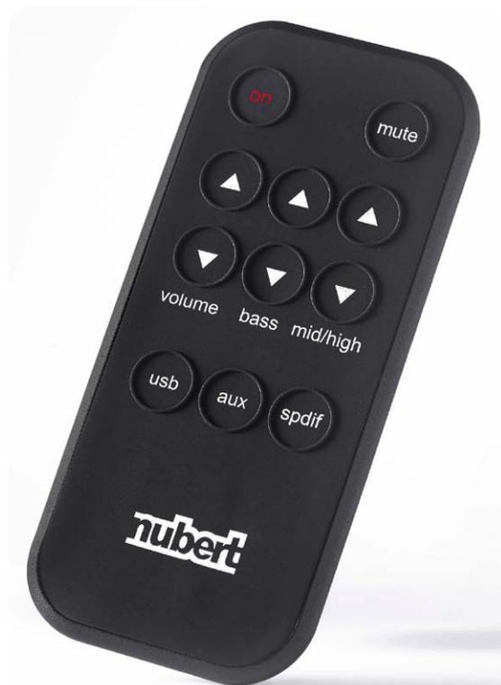
Die kleine Fernbedienung bietet dank der gummierten Oberfläche eine gute Haptik
