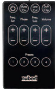
sorgte Verstärkermodul an. Eine Infrarotfernbedienung ermöglicht die Steuerung sämtlicher Einstellungen von der Couch. Das Display auf der Stirnseite des Subwoofers liefert dabei das nötige Feedback durch Anzeige aller relevanten Parameter.
