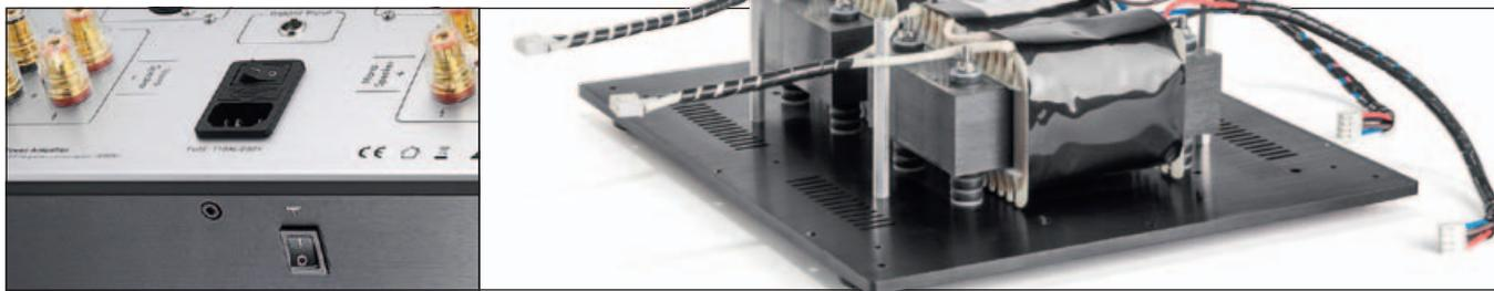
**VERSTECKTE HELDEN:** Auf der Unterseite hat Nubert eine zuschaltbare Erdung gegen Brummschleifen installiert (links). Foto rechts: Auf der Bodenplatte wurden zwei Dual-Mono-Hochleistungstrafos verschraubt und verkapselt.
