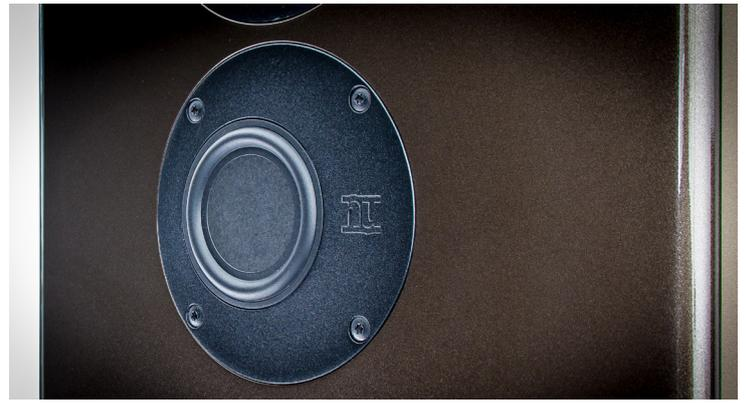
Der Hochmitteltöner hat einen seitlichen Versatz, außergewöhnlich ist auch seine Ausführung als Flachmembran mit kleiner Membranfläche, sie ist als Sandwich mit Wabenstruktur aufgebaut.
