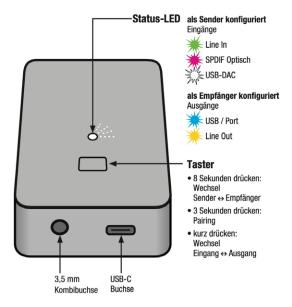
Das LED-Piktogramm zeigt an, ob der trX als Sender oder Empfänger arbeitet. Zudem visualisiert er, ob der analoge oder digitale Audioanschluss aktiv ist
