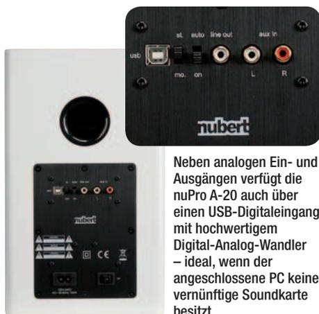
Neben analogen Ein- und Ausgängen verfügt die nuPro A-20 auch über einen USB-Digitaleingang mit hochwertigem Digital-Analog-Wandler – ideal, wenn der angeschlossene PC keine vernünftige Soundkarte besitzt
