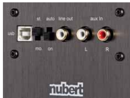
Bei Nutzung eines einzelnen Monitors ermöglicht der Stereo/Monoschalter den Monobetrieb
