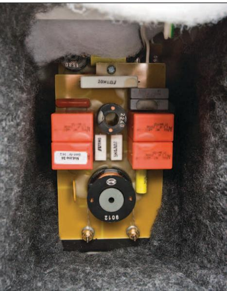
Die Frequenzweiche ist hochwertig bestückt und auf einer Platine aufgebaut
