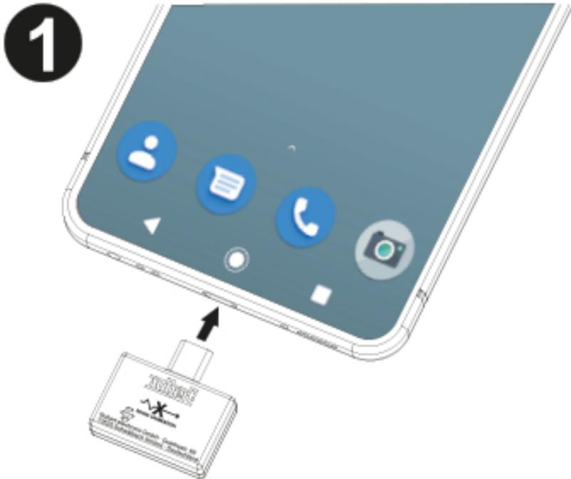
Stecken Sie das XRC Android Interface an den USB-C Anschluss Ihres kompatiblen Android Geräts. Sollte das Gerät über keinen USB-C Anschluss verfügen, so kann ein handelsüblicher Micro-USB-Adapter verwendet werden.
