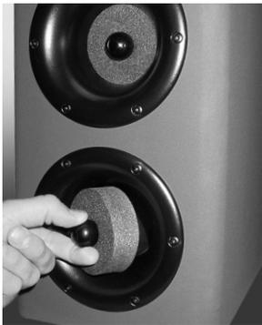
Bitte Pfropfen mindestens 4 cm tief ins Rohr hineindrücken, damit sie vom Grat der Trompeten/Rohrverbindung gehalten werden. Sonst besteht die Gefahr, dass starke Bassimpulse sie wieder aus dem Rohr herausschleudern.
