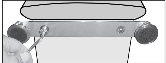
Bitte überprüfen Sie die Vollständigkeit der Teile. Die Traversenfüße werden wie abgebildet an den Gewindebuchsen (M8) auf dem Boden der Gehäuse festgeschraubt. Der Lautsprecher liegt dabei idealerweise flach auf der Rückwand. Sind beide Traversen fest an das Gehäuse montiert, kann der Lautsprecher in die Hörposition aufgestellt werden.
