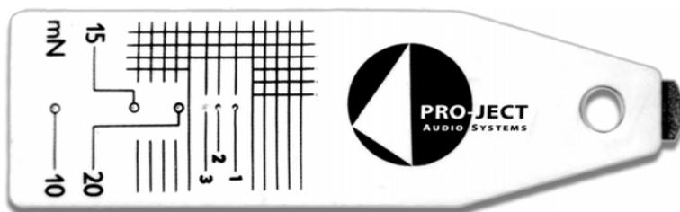
Um die für den zu montierenden Tonabnehmer empfohlene Auflagekraft einzustellen, senken Sie die Nadelspitze auf einen der drei beschrifteten Messpunkte (10, 15 und 20mN) oder einem gedachten Punkt zwischen den Messpunkten ab, welcher der empfohlene Auflagekraft entspricht. Steht die Waage danach waagrecht, ist die Auflagekraft korrekt.
