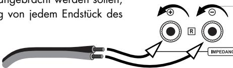
Drehen Sie den Knopf nun im Uhrzeigersinn, um den Draht in der Lautsprecherklemme festzuklemmen. Achten Sie darauf, dass die Verschraubung fest ist.
