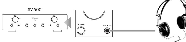
Dadurch werden die Lautsprecher abgeschaltet. Es können alle Kopfhörer mit einer Impedanz zwischen 32 Ohm und 600 Ohm verwendet werden. Ungeeignete Kopfhörer mit zu niedriger Impedanz können den Verstärker beschädigen oder unerwartet eine so hohe Lautstärke produzieren, dass Ihr Gehör geschädigt werden kann. Vor dem Einsticken sollte vorsichtshalber die Lautstärke am Drehknopf bzw. an den Tasten „VOLUME“ (8)(21) reduziert werden.
