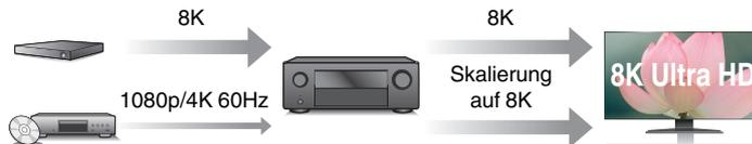
Dieses Gerät ist mit einer Funktion zur Aufwärtsskalierung auf 8K-Video ausgestattet, so dass Sie Videos mit 1080p/4K über HDMI mit 8K-Auflösung (7680 × 4320 Pixel) ausgeben können. Mit dieser Funktion können Sie das Gerät über ein einzelnes HDMI-Kabel an einen Fernseher anschließen und so hochauflösende Bilder für jede Videoquelle erzeugen.
