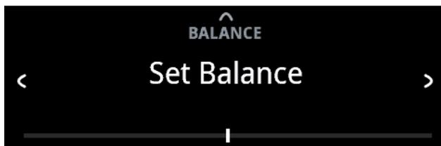
Mit dem Balance-Regler wird der relative Pegel des linken und rechten Kanals eingestellt.
