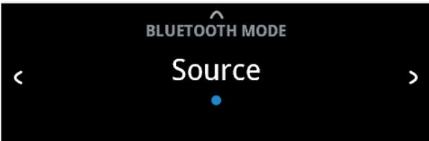
Wählen Sie im „Bluetooth-Modus“ „SOURCE“. Stellen Sie sicher, dass die Bluetooth-Antenne mit dem BT-Antennenanschluss auf der Rückplatte verbunden ist.
