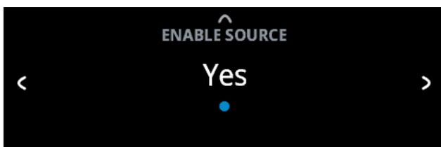
Mit dieser Option kann ein nicht verwendeter Ein- oder Ausgang freigegeben bzw. gesperrt werden. Dies ist besonders nützlich, wenn nur wenige Quellen verwendet werden, wodurch ungenutzte Quellen umgangen werden.
