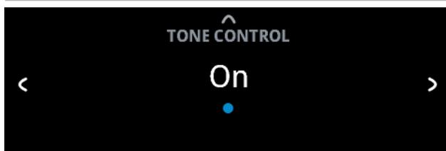
Die Tonregelung ermöglicht das Verstärken und Reduzieren bestimmter Audiofrequenzen. Die Höhen- und Tiefenregler („Bass“ und „Treble“) können ein- und ausgeschaltet werden.
