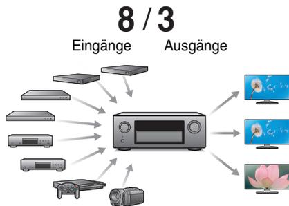
Dieses Gerät stellt für den Anschluss zahlreicher verschiedener digitaler Quellen 8 HDMI-Eingänge bereit, darunter einen an der Vorderseite, über den Sie schnell und bequem eine Videokamera, eine Spielekonsole oder ein anderes mit HDMI ausgestattetes Gerät anschließen können. Es gibt zwei HDMI-Ausgänge für den Hauptraum und einen dritten HDMI-Ausgang für einen weiteren Raum.
