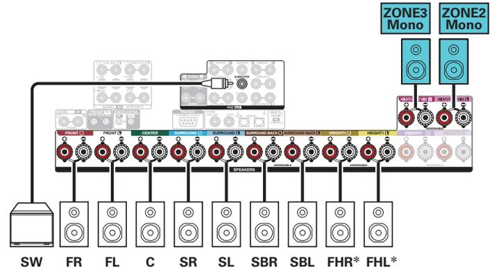
\* Die Hochtöner, die Deckenlautsprecher und die Dolby Atmos Enabled-Lautsprecher können an die HEIGHT1-Lautsprecheranschlüsse angeschlossen werden. Legen Sie über "Height" - "Layout" im Menü den anzuschließenden Lautsprecher fest. (🔧 S. 232)
