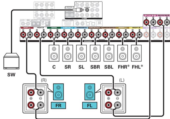
\* Die Hochtöner, die Deckenlautsprecher und die Dolby Atmos Enabled-Lautsprecher können an die HEIGHT1-Lautsprecheranschlüsse angeschlossen werden. Legen Sie über "Height" - "Layout" im Menü den anzuschließenden Lautsprecher fest. (☞ S. 232)
