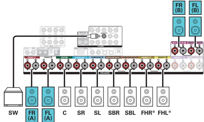
\* Die Hochtöner, die Deckenlautsprecher und die Dolby Atmos Enabled-Lautsprecher können an die HEIGHT1-Lautsprecheranschlüsse angeschlossen werden. Legen Sie über "Height" - "Layout" im Menü den anzuschließenden Lautsprecher fest. (☞ S. 232)
