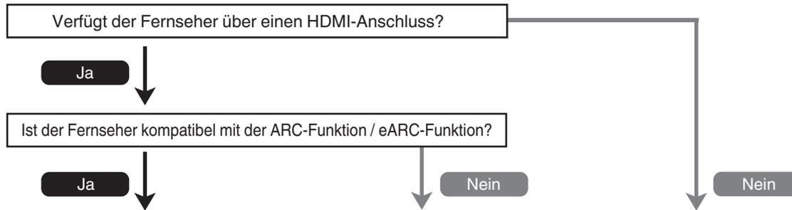
**“Anschlussweise 1: Der Fernseher verfügt über einen HDMI-Anschluss und ist kompatibel mit ARC (Audio Return Channel) / eARC (Enhanced Audio Return Channel)”** (☞ S. 82)
