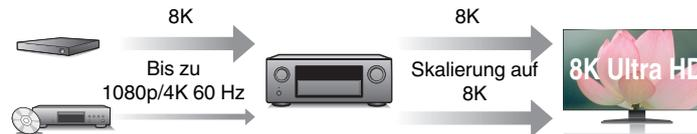
Dieses Gerät ist mit einer Funktion zur Aufwärtsskalierung auf 8K-Video ausgestattet, so dass Sie Videos mit SD (Standard Definition) oder HD (High Definition) (4K, 60 Hz) über HDMI mit 8K-Auflösung (7680 × 4320 Pixel) ausgeben können. Mit dieser Funktion können Sie das Gerät über ein einzelnes HDMI-Kabel an einen Fernseher anschließen und so hochauflösende Bilder für jede Videoquelle erzeugen.
