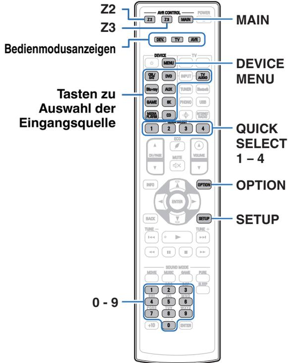
Wenn in der beiliegenden Fernbedienung voreingestellte Codes programmiert sind, kann sie zur Steuerung der von Ihnen genutzten Geräte, wie z. B. DVD-Player oder Fernsehgeräte von verschiedenen Herstellern, verwendet werden.
