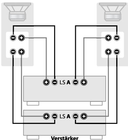
Für gleich niedrige Kabelverluste (gegenüber konventioneller Technik) benötigt man sowohl bei Bi-Wiring als auch bei Bi-Amping den doppelten Kabelaufwand. Jede der Leitungen für den Bass/Mitten- und Hochton-Bereich erfordert den vollen Leitungsquerschnitt.
