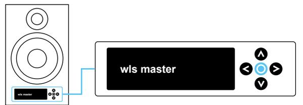
Eine bestehende Verbindung wird kurz mit **connected** bestätigt und lässt sich dauerhaft am Symbol ((←→)) auf dem Display ablesen. Das empfangene kabellose Signal wird nun am Eingang wireless (wls) bereitgestellt und kann wie jede andere Quelle ausgewählt werden.
