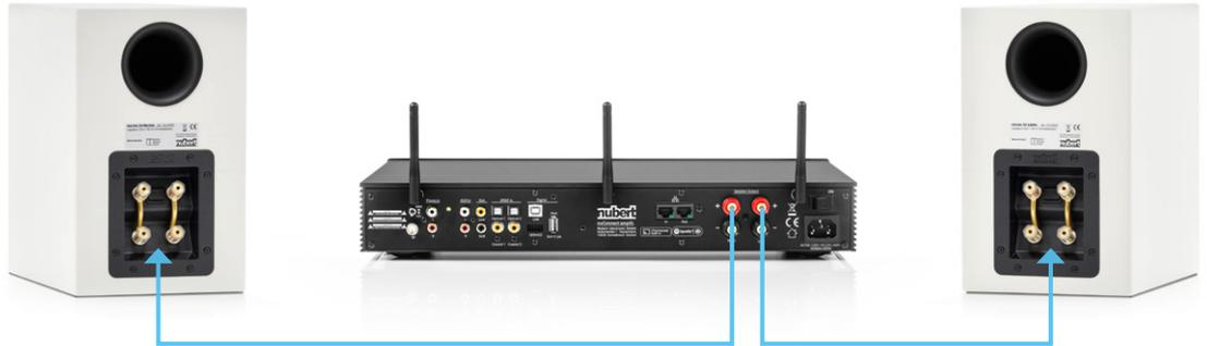
Der nuConnect muss dazu als **wls slave** eingerichtet und mit dem Sender verbunden werden. Er bleibt dabei voll bedienbar. Die Stand-by-Leistungsaufnahme beträgt mit aktiviertem Funkmodul weniger als 2 Watt.
