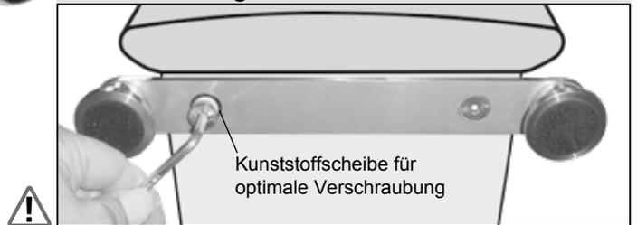
Bitte überprüfen Sie die Vollständigkeit der Teile. Die Traversenfüße werden wie abgebildet an den Gewindebuchsen (M8) auf dem Boden der Gehäuse festgeschraubt. Der Lautsprecher liegt dabei idealerweise flach auf der Rückwand. Sind beide Traversen fest an das Gehäuse montiert, kann der Lautsprecher in die Hörposition aufgestellt werden.
