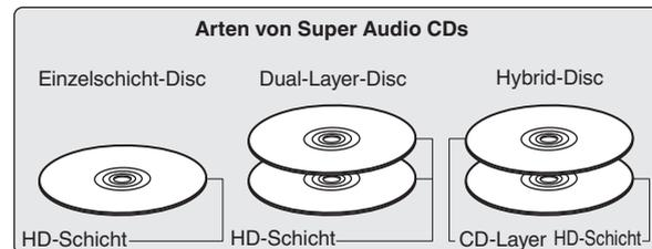
Die HD-Schicht ist eine Schicht von High Density-Signalen für Super Audio CDs.
