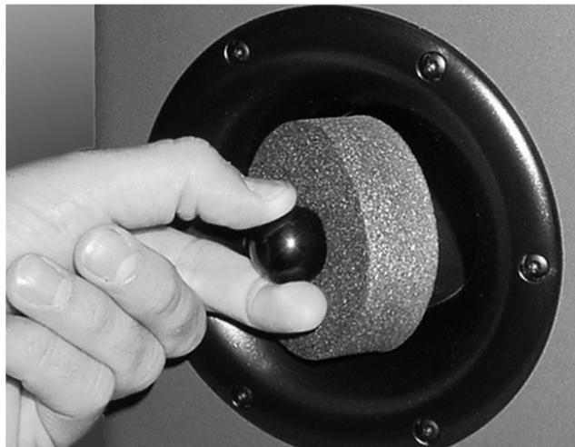
Bitte Pfropfen mindestens 4 cm tief ins Rohr hineindrücken, damit sie vom Grat der Trompeten/Rohrverbindung gehalten werden. Sonst besteht die Gefahr, dass starke Bassimpulse sie wieder aus dem Rohr herausschleudern.
