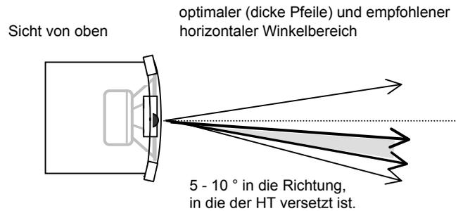
Für beste Natürlichkeit des Klangbildes empfiehlt sich also – abhängig von der Hörentfernung – eine *recht starke* Neigung der Box nach hinten. Bei größerem Abhörwinkel *nach oben* (also *wenig* nach hinten geneigter Box) werden die mittleren Frequenzen etwas schwächer wiedergegeben. Das ergibt klanglich eine leichte *Loudness-Charakteristik*, die aber von vielen nuForm-60-Fans sogar bevorzugt wird.
