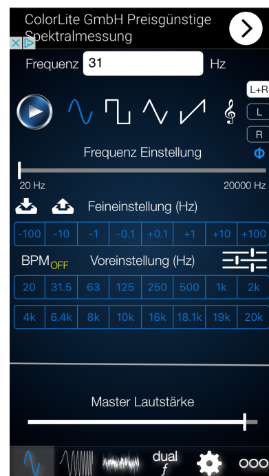
Abbildung 15: Die iOS App „AfG – Audio Funktionsgenerator“ (Link zum AppStore) bietet eine ebenso einfache Bedienung: Oben lässt sich die Frequenz auswählen und darunter die Art des Signals. Für unsere Anwendung ist das erste Symbol (geschwungene Welle) die korrekte Option. Am unteren Ende können Sie die Lautstärke und den Sweep einstellen. Wählen Sie hier wieder das ganz linke wellenförmige Signal.
