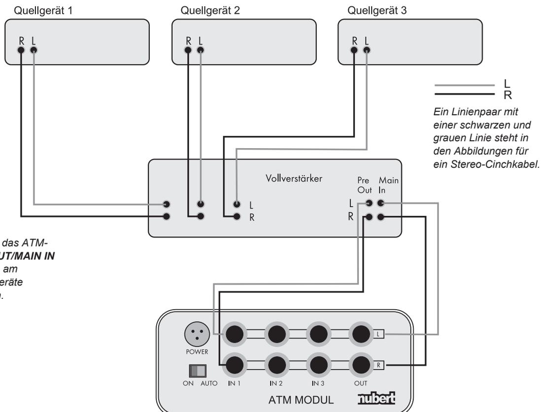
1) Der Anschluss eines ATM-Moduls an eine **Vorverstärker/Endverstärker-Kombination** entspricht dem Anschluss-Schema auf dieser Seite.
