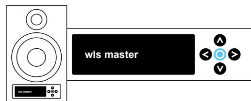
Eine bestehende Verbindung wird kurz mit **connected** bestätigt und lässt sich dauerhaft am Symbol **((--))** auf dem Display ablesen. Das empfangene kabellose Signal wird nun am Eingang wireless (wls) bereitgestellt und kann wie jede andere Quelle ausgewählt werden
