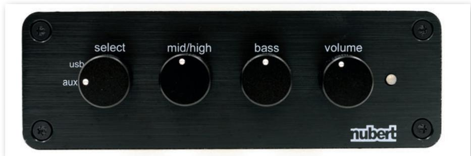
Das Einstell-Panel: Der A-20 hat ein eingebautes USB-Audio-Interface für den Direktanschluss an den Rechner, hinter den Reglern „mid/high“ und „bass“ verbirgt sich eine ungewöhnliche Klangregelung.
