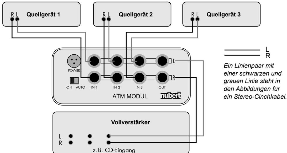
**Bitte beachten:** Manche CD- und DVD-Player können bei Vollaussteuerung der CD bis zu 2 Volt (effektiv) liefern. Wenn nun ein voll ausgesteuertes Bass-Signal mit dem ATM-Modul in EQ-Stellung „Mitte“ (also um etwa 10 Dezibel) angehoben wird, entspricht das etwa einer Verdreifachung des Spannungswertes. Beim Einsatz des ATM-Moduls zwischen CD-Player und Verstärkereingang – oder auch beim Einschleifen in den „Tape-Monitor“ – kann
