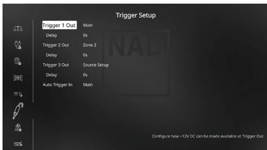
Der T 778 verfügt über drei konfigurierbare +12V DC Trigger-Ausgänge, die zur Aktivierung einer Komponente oder eines Systems verwendet werden können, in die/das er gespeist wird. Es ist auch ein Triggereingang vorhanden, mit dem die zugeordnete Verbindung aktiviert werden kann.
