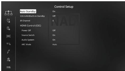
Der T 778 unterstützt HDMI-Steuerungs- (CEC) und Audio Return Channel (ARC)-Funktionen. Beide Funktionen sind möglich, wenn externe Geräte, die ebenfalls beide Features unterstützen, über den HDMI-Anschluss mit dem T 778 verbunden sind.
