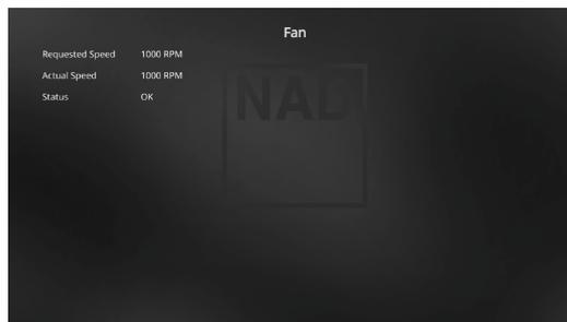
Die Lüftergeschwindigkeit und der Lüfterstatus werden angezeigt.
