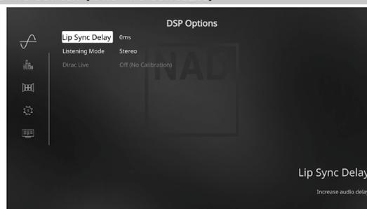
Die folgenden Signalverarbeitungsparameter können im Menü „DSP-Optionen“ (Digital Signal Processing; digitale Signalverarbeitung) eingerichtet werden.
