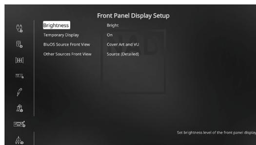
Das vordere Display und das OSD (On-Screen Display) können durch Einstellen der Parameter im Menü „Front Panel Display Setup“ (Einstellen der Anzeige auf der Frontplatte) auf vielfältige Weise konfiguriert werden.
