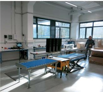
**In der Warenkontrolle** werden in Stichproben fertige Geräte auf Funktion und Fehler überprüft (links), zum Abgleich stehen im Regal nebenan (rechts) die perfekten Muster.
