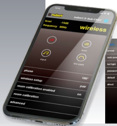
Nubert X-Remote App: umfassende Steuerung des Subwoofers inklusive innovativer Einmessfunktion* zur Raumanpassung (mit Display-Beispielen).
