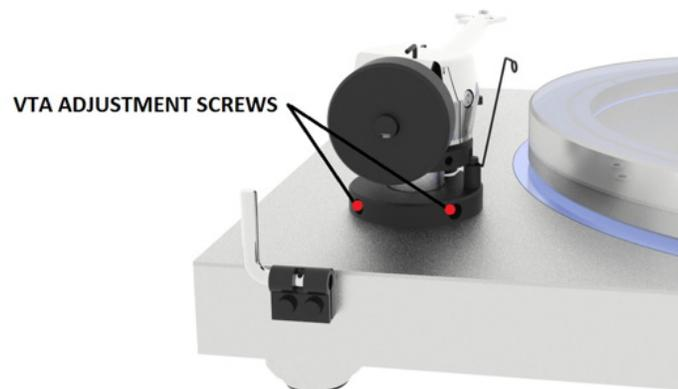
Um den Vertikalen Spurwinkel (VTA) einzustellen, legen Sie zunächst eine Schallplatte auf den Plattenteller. Sobald die Nadel in die Aufnahme-ritze der Schallplatte abgesenkt ist, sollte der Tonarm parallel zur Oberfläche der Platte ausgerichtet sein. Ist dies nicht der Fall, lockern Sie beide Sechskantschrauben der Tonarmbasis (VTA Adjustment
