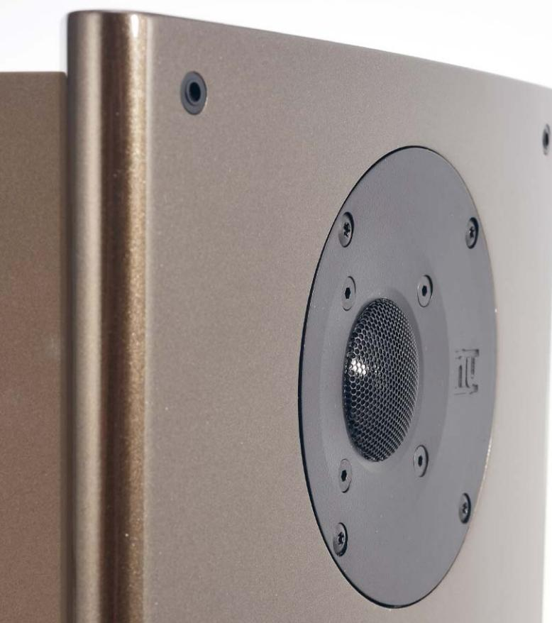
Die hochglanzlackierte Schallwand ist leicht gebogen, um Kantenreflexionen vom Hörer fernzuhalten. Die neue Seidenkalotte ist in eine mehrstufige Schallführung asymmetrisch zur Mitte eingebaut.
