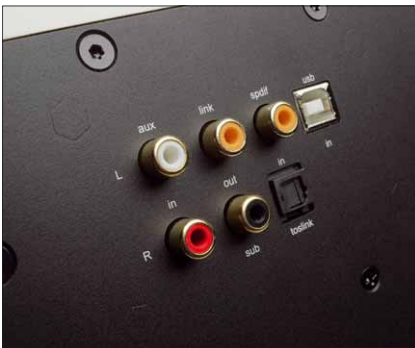
Zusätzlich zu Digital- und Analogeingängen gibt es einen Sub-out und die Link-Buchse zur optimalen Versorgung der Slave-Box
