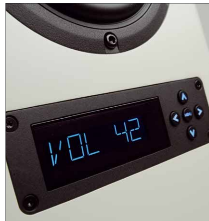
Neben der Displaybedienung zur vollständigen Konfigurierung gibt es eine Fernbedienung für die nötigsten Funktionen wie Lautstärke und Quellen
