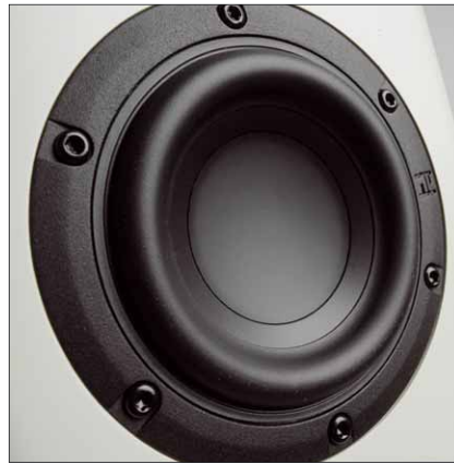
Der Tieftöner mit 120-mm-Korb ist hervorragend gemacht. Sein Druckgusskorb bringt Stabilität, der Langhubantrieb sorgt für Potenz im Frequenzkeller
