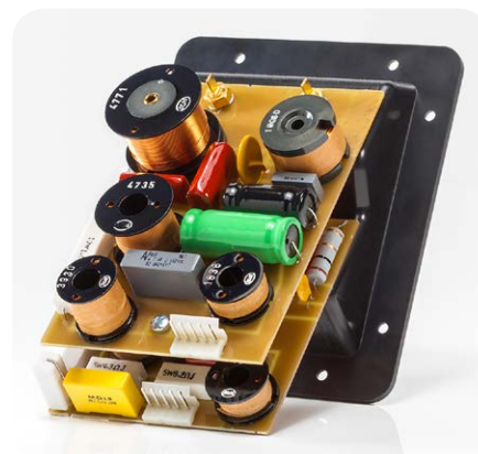
Die Frequenzweiche sitzt direkt hinter den vergoldeten Polklemmen
