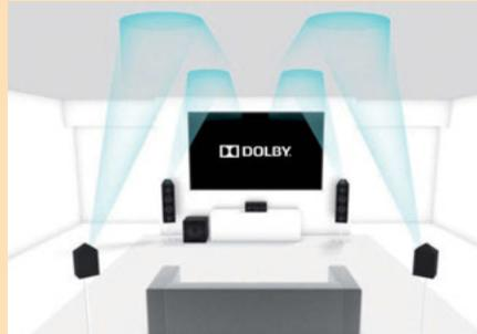
**Per Reflexion von der Decke** sollen die Atmos-Chassis getrennte Lautsprecher für die Höhen-Kanäle überflüssig machen.
