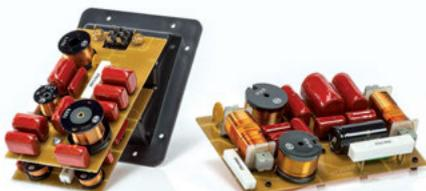
Die Frequenzweichen der nuVero-Serie, hier die des Centers, sind aufwändig konstruiert und verteilen sich deshalb auf mehrere Platinen.
