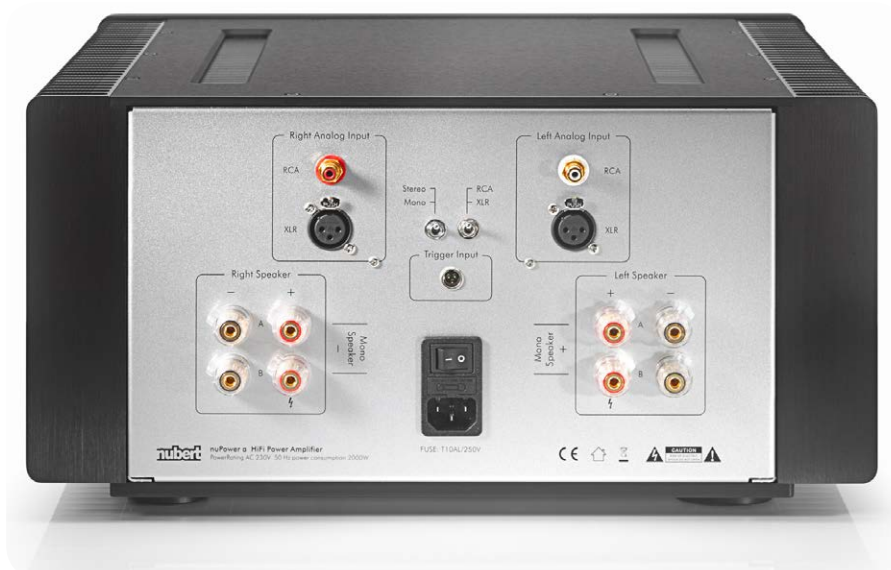
Der nuPower A besitzt symmetrische und unsymmetrische Analogeingänge. Diese können getrennt geschaltet werden, um zum Beispiel zwei Vorstufen oder Audiozuspieler gleichzeitig zu verbinden
