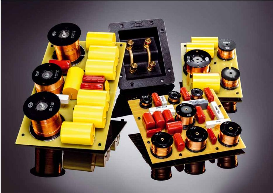
Aufwendig mit hochwertigen Bauteilen bestückte Frequenzweichen dienen in der nuVero für optimale Performance
