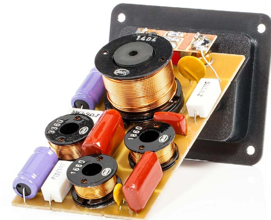
Die aufwändig konstruierte Frequenzweiche sitzt huckepack hinter dem Terminal
