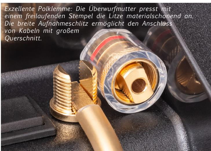
*Exzellente Polklemme: Die Überwurfmutter presst mit einem freilaufenden Stempel die Litze materialschonend an. Die breite Aufnahmeschlitz ermöglicht den Anschluss von Kabeln mit großem Querschnitt.*
