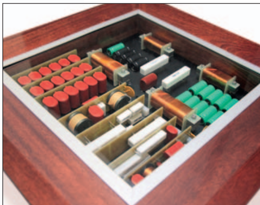
Die Frequenzweiche ist im Sockel der Pyramide eingelassen. Klangwahlschalter und die Option, zwischen Direkt- und Rundumstrahlmodus zu wechseln, machen die Schaltung extrem kompliziert.
