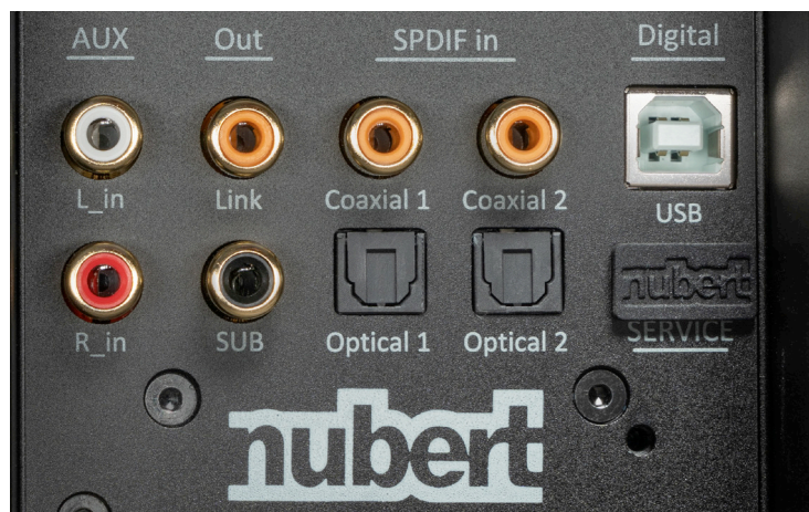
Schnittstellen-Vielfalt: Die X-Serie bietet mit einem weiteren optischen und einem zusätzlichen elektrischen Eingang zwei S/PDIF-Inputs mehr.
