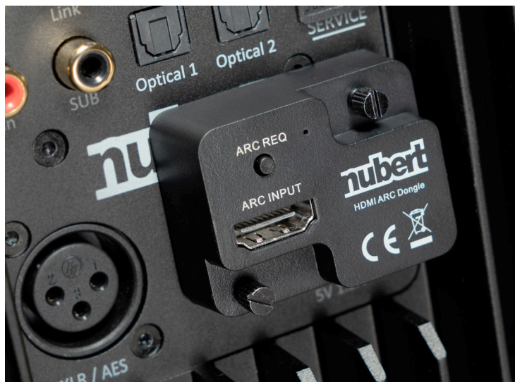
Über dem HDMI/ARC-Adapter kann man den TV-Ton oder die Tonspur vom Blu-ray-Player einspeisen.
