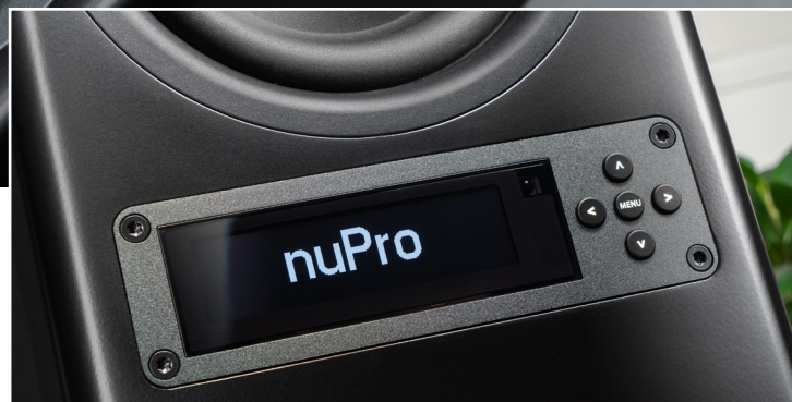
Das OLED-Display sieht sehr edel aus. Über diese Anzeige und das Steuerkreuz können sämtliche Einstellungen an der Box vorgenommen werden.
