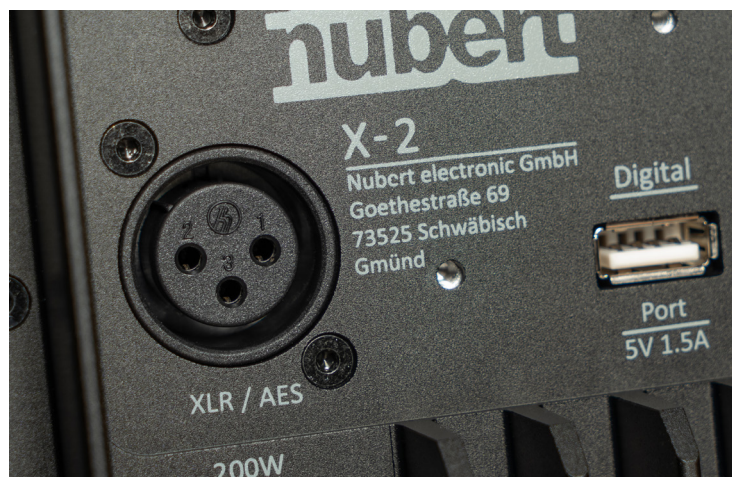
Das audiophile Plus ist der XLR-Eingang: Er kann analog als symmetrischer Input genutzt werden oder digital als AES/EBU-Schnittstelle. Beide Anschlussnormen stammen aus dem Profi-Bereich.
