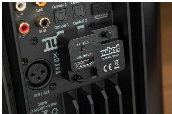
Mit dem mitgelieferten HDMI/ARC-Adapter wird aus dem USB-A-Port ein HDMI-Eingang für den Ton vom Fernseher oder vom Blu-ray-Player.
