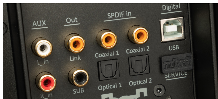
Anschluss-Reichtum: Die nuPro X-Modelle bieten zwei S/PDIF-Inputs mehr als ihre Schwestern aus der A-Reihe.
