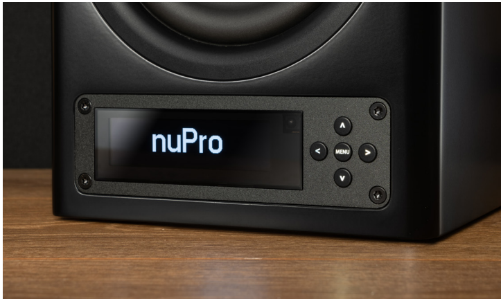
Das OLED-Display sorgt für eine elegante und gestochen scharfe Anzeige des Betriebszustands. Im Verbund mit den beleuchteten Tasten können sämtliche Einstellungen schnell und leicht an der Box vorgenommen werden.
