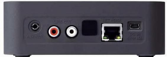
und AIFF-Dateien mit 192 kHz/24 bit und ALAC mit 96 kHz/24 bit. Innerhalb der App werden neben dem ausgewählten Sender bzw. Quelle auch der Musiktitel, das Dateiformat und ihre Auflösung angezeigt. Ist der Yamaha-Adapter über den 3,5-mm-Klinkenausgang verbunden, lässt sich die Lautstärke via App regeln. Yamahas Musiccast ist zudem für Multiroom-Anwendungen ausgelegt, sodass man den WXAD-10 auf Wunsch auch mit anderen Komponenten ins Heimnetzwerk einbinden kann.
