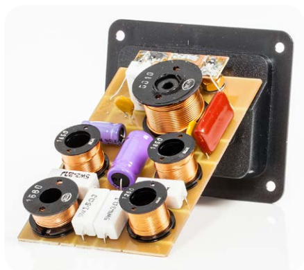
Die aufwändig konstruierte Weiche sitzt direkt hinter dem Kabelanschlussfeld
