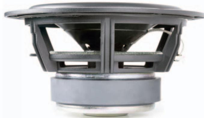
Upgrade inklusive: Der 18er bietet erkennbar einen geringen Schwingspulendurchmesser, dafür umso mehr Hub bei Sicke und Zentrierung. Die Membran besteht aus zwei verklebtem Konusteilen.
