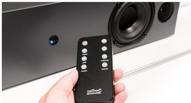
*Die Quellwahl geschieht ausschließlich per Fernbedienung. Welche Quelle gerade angewählt ist, erkennt man an dem farbigen LED-Indikator in der Front. Dieser ist übrigens auch durch die Frontabdeckung hindurch sichtbar.*
