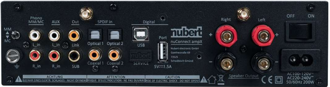
Neben einem Phono-Preamp für MM und MC hat man dem ampX auch einen digitalen Festpegel-Link-Out spendiert, über den man das gerade gehörte Signal entweder weiterleiten oder mit einem Computer auch mitschneiden kann
