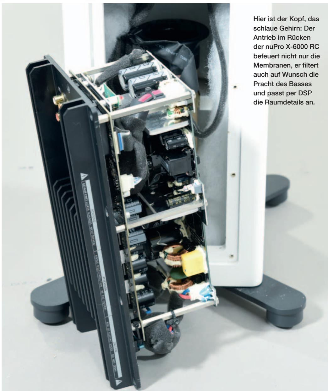
Hier ist der Kopf, das schlaue Gehirn: Der Antrieb im Rücken der nuPro X-6000 RC befeuert nicht nur die Membranen, er filtert auch auf Wunsch die Pracht des Basses und passt per DSP die Raumdetaill an.
